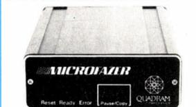
Buffer d'imprimante de 16 jusqu'à 128 K. Cet interface série ou // (à préciser) se branche directement sur votre imprimante et permet la buffering de vos données. Cela veut dire que qu'elle que soit la vitesse du printer (un modem, plotter), après quelques secondes, votre ordinateur recevra disponible, les données à transmettre n'étant plus dans votre RAM mais dans la RAM du Microfazer.
